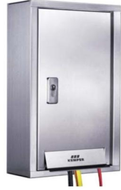
KEMPER 'Kasa' duvara monte dolap, figür 213, H/B/T: 510x285x130 mm, bitmiş hazır duvara hızlı ve temiz monte etmek için ve sıva altına gömmek için yeterli yer bulunmayan duvar kalınlığında
