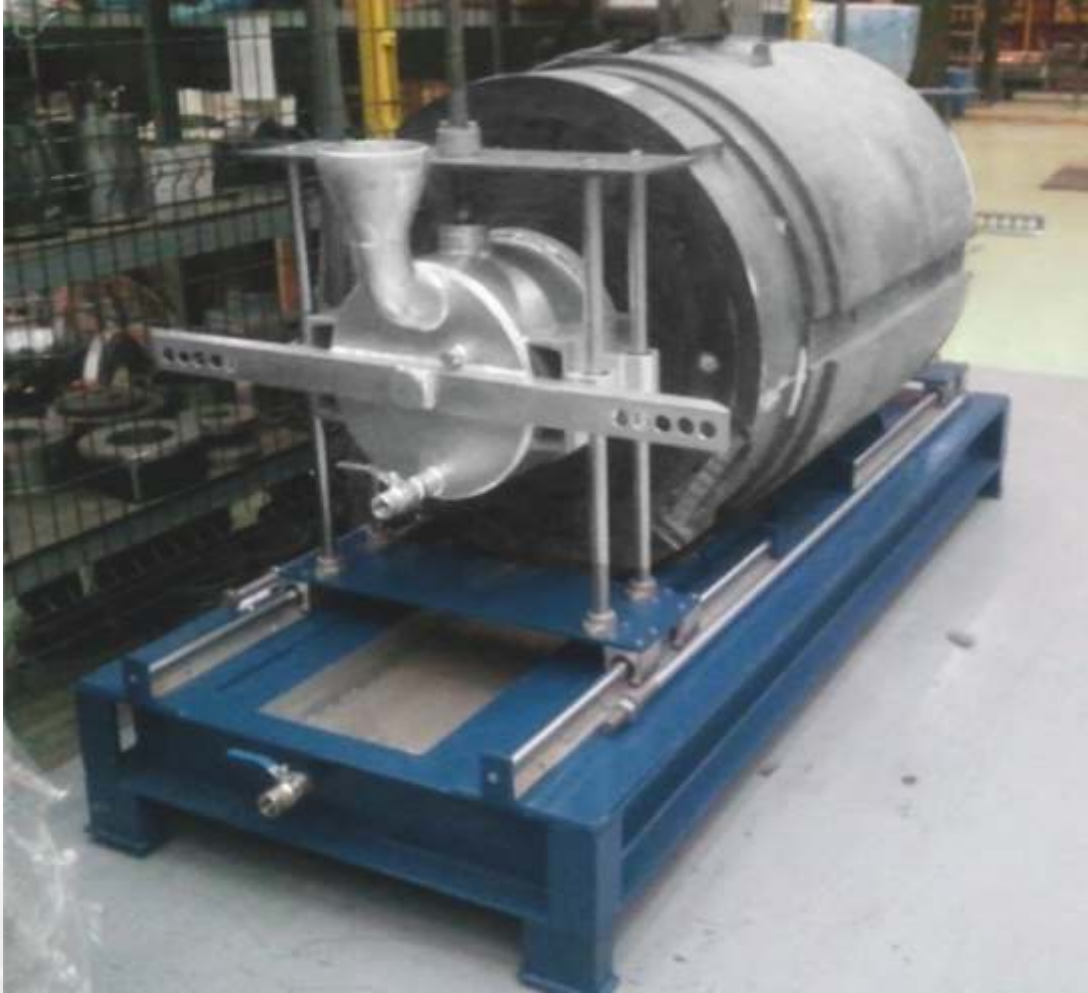
Tambur iç yüzey temizleme için kostikleme makinası
