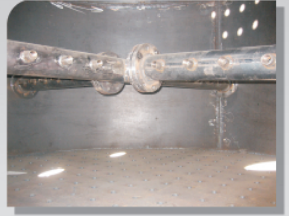
Filtre İç Nozul Boru Detayı
